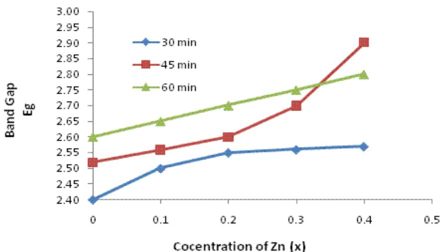
**FIG.3.** Concentration of Zn Vs Band Gap for 30 min, 45 min and 60 min.
